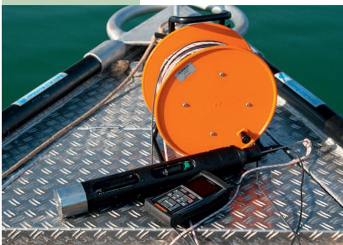
Wie schon im Editorial von unserem Obmann angekündigt, wurde vom SAB ein digitales Messgerät für den Irrsee angekauft. Mit diesem kompakten Präzisions-Messgerät können wir jetzt schnell und zuverlässig pH-Redox-, Leitfähigkeit und Sauerstoffmessungen durchführen.
