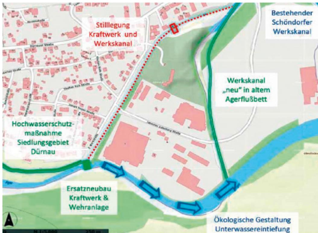
Diese Grafik zeigt uns übersichtlich das gesamte Projekt des Kraftwerksbau. Das Kraftwerk selbst wird in Trockenbauweise gebaut. Die meisten Eintrübungen werden durch die nötigen Vertiefungen des Flussbettes unterhalb der Wehranlage entstehen. Um die Baustelle selbst trocken zu halten, wird die Ager kurzzeitig um die Baustelle durch ein Ersatzgerinne umgeleitet.
